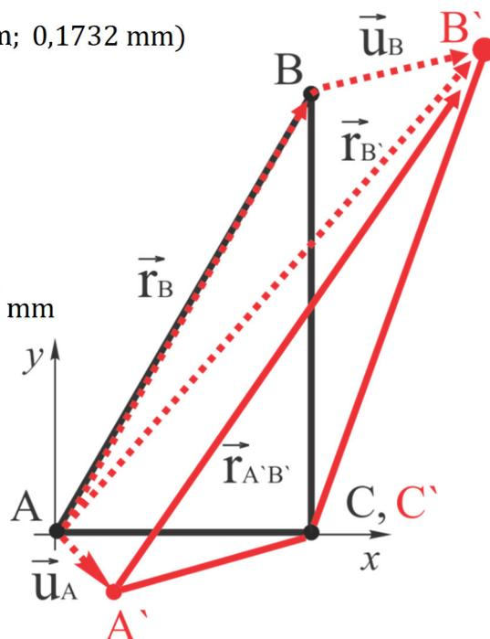
Za izračun spremembe kota  $\alpha$  si pomagamo s kosinusnim izrekom (v vektorski obliki). Ker je deformacijsko stanje homogeno, si lahko točni položaj kota  $\alpha$  na daljici AB poljubno izberemo. Zaradi lažjega računanja si izberemo položaj po spodnji sliki (točka D naj sovpada s točko C):
