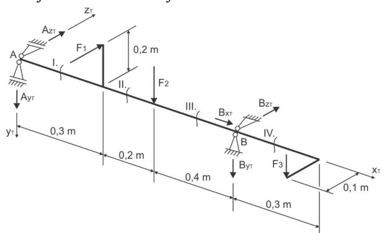
**a)** Nosilec je statično predoločen, saj nobena izmed podpor ne preprečuje rotacije nosilca okrog osi  $x_T$ . Zaradi tega med neznanki, ki jih moramo določiti iz statike, poleg sil v podporah, sodi tudi sila  $F_3$ , ki mora biti določena tako, da je izpolnjeno ravnovesje momentov okrog osi  $x_T$ .
