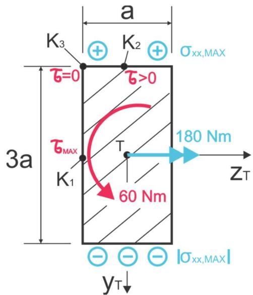
\*\* Dimenzioniranje na primerjalno napetost v točki K<sub>2</sub>:
