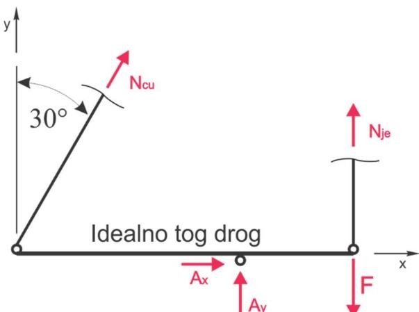
c) Zapišemo deformacijsko enačbo. Predpostavimo, da se jeklena palica raztegne, bakrena pa skrči. Idealno tog drog je nedeformabilen in se premakne kot togo telo (rotira okrog točke A). Ker so premiki majhni, lahko zanemarimo, da se vozlišča na drogu dejansko premikajo po krožnici (obravnavamo, kot da se vseskozi premikajo v isti smeri kot ob začetku deformiranja).
